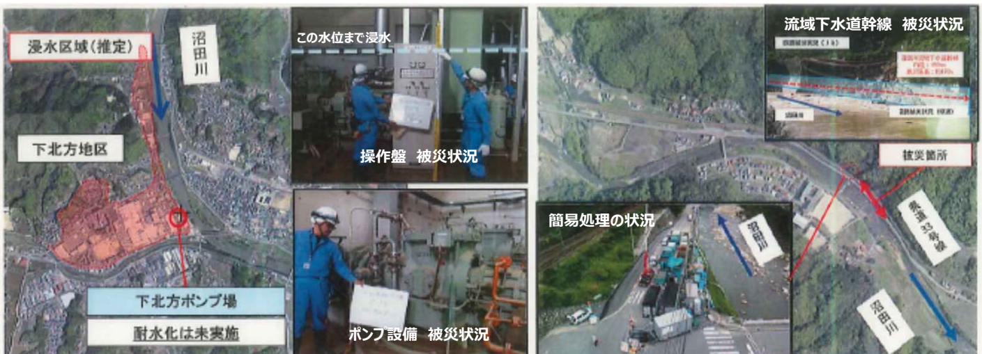
今回の豪雨において道路が崩落し流域下水道幹線(汚水)が流出。 応急復旧として濁水処理装置を設置し簡易処理を実施。 (広島県東広島市)
