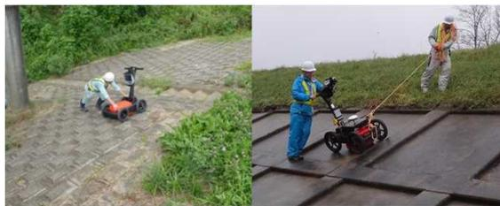
地中レーダ探査等非破壊検査
